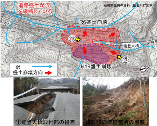
△能登半島地震の事例：複雑な集水地形かつ、う回路の確保が困難な橋台取付部で、広い範囲の盛土が崩壊
