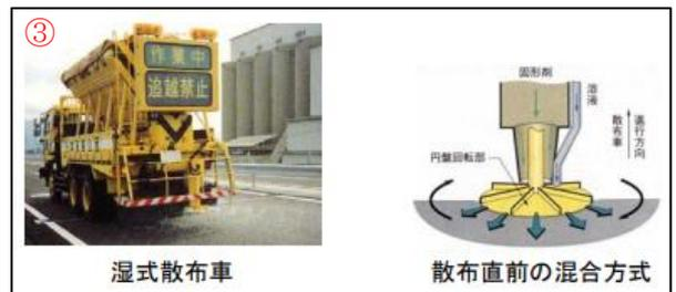
図1 固形剤散布車①、溶液散布車②、湿式散布車③
