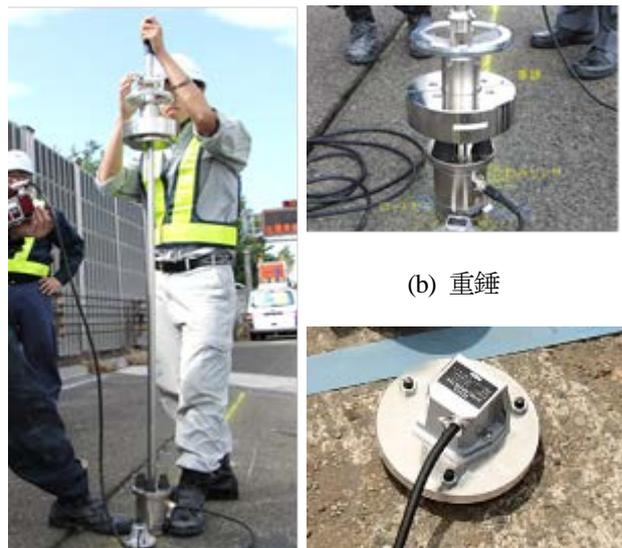
(a) 小型 FWD 試験機 (b) 重錘 (c) サーボ式加速度計
