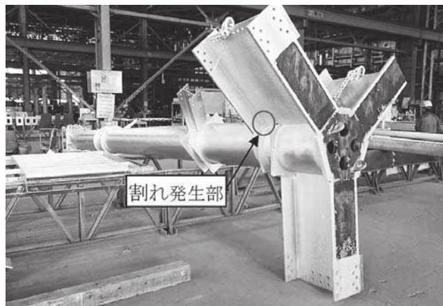
図1 めっき割れが発生した柱材の全体図
