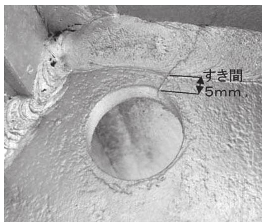
めっき抜き孔の割れ発生事例
