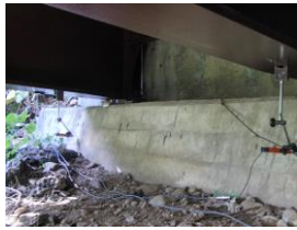
写真-3, 4 変位計（水平）設置状況
