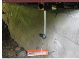
写真-3, 4 変位計（水平）設置状況
