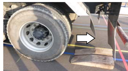
写真-1 踏み台落下試験状況
