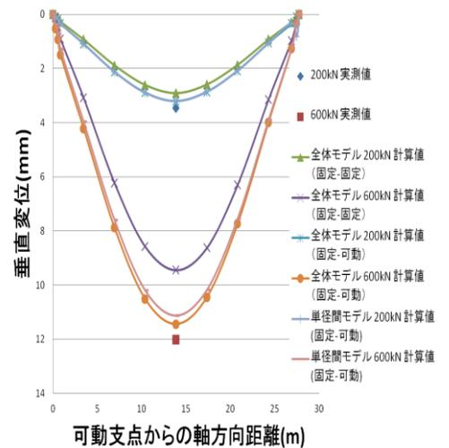
図-5 G3 桁の垂直変位分布図
