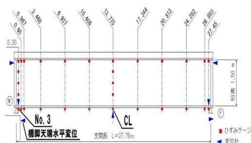
図-2 橋脚，支承，桁における計測位置
