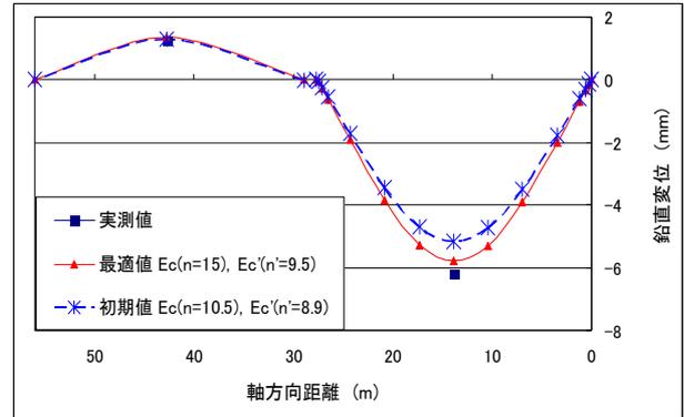
図-2 G1 桁の垂直変位分布図
