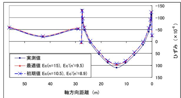
図-3 G1 桁下フランジ下面の軸方向ひずみ分布図
