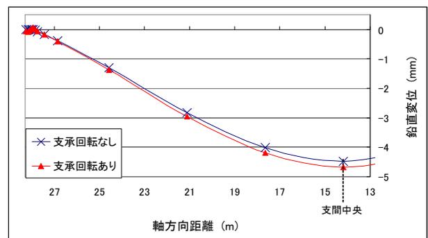
図-4 支承の回転の有無による垂直変位分布図
