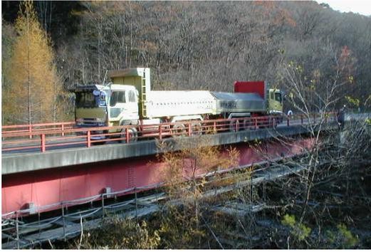
写真-1 第1回目の試験状況
