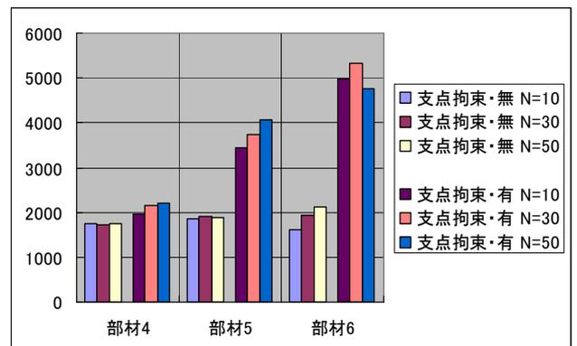
図 - 4 最大せん断力の比較 (単位 : kN)
